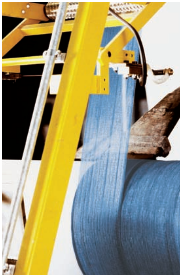
Principe de revêtement ZMU des tubes
