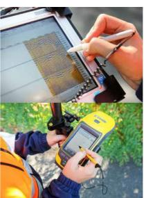
La principale difficulté d'utilisation réside dans le fait que les échos radar mesurés peuvent être générés par le réseau à localiser mais également par toute autre hétérogénéité du sous-sol prospecté (terrains argileux, anciennes canalisations inutilisées, vide sous chaussée, humidité trop importante, etc.). Toutes les informations obtenues par d'autres investigations ou auprès d'un exploitant par des plans ou un SIG, viendront étayer les observations faites par le géoradar.
